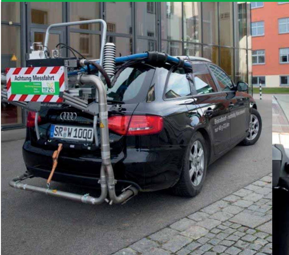
Messaufbau am Fahrzeugheck
